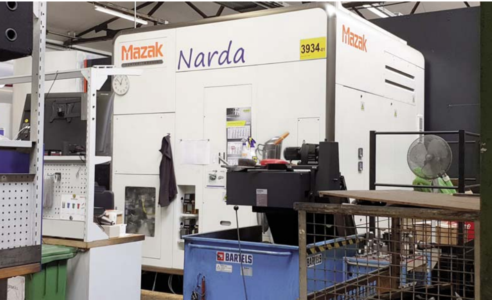
Knott bearbeitet die Bauteile auf einer Mazak Vortex 630 V/6, die mit einer weiteren Maschine und einer Beladestation für Spanntürme zu einer Maschinengruppe angeordnet ist. Bild: INGERSOLL
