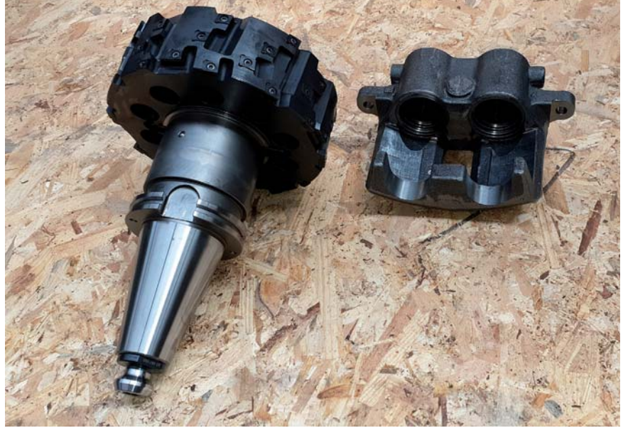
Das Bauteil, ein hydraulischer Gleitsattel, und das für die Bearbeitung des Bremsscheiben-Durchgangs maßgeschneiderte Werkzeug. Bild: INGERSOLL
