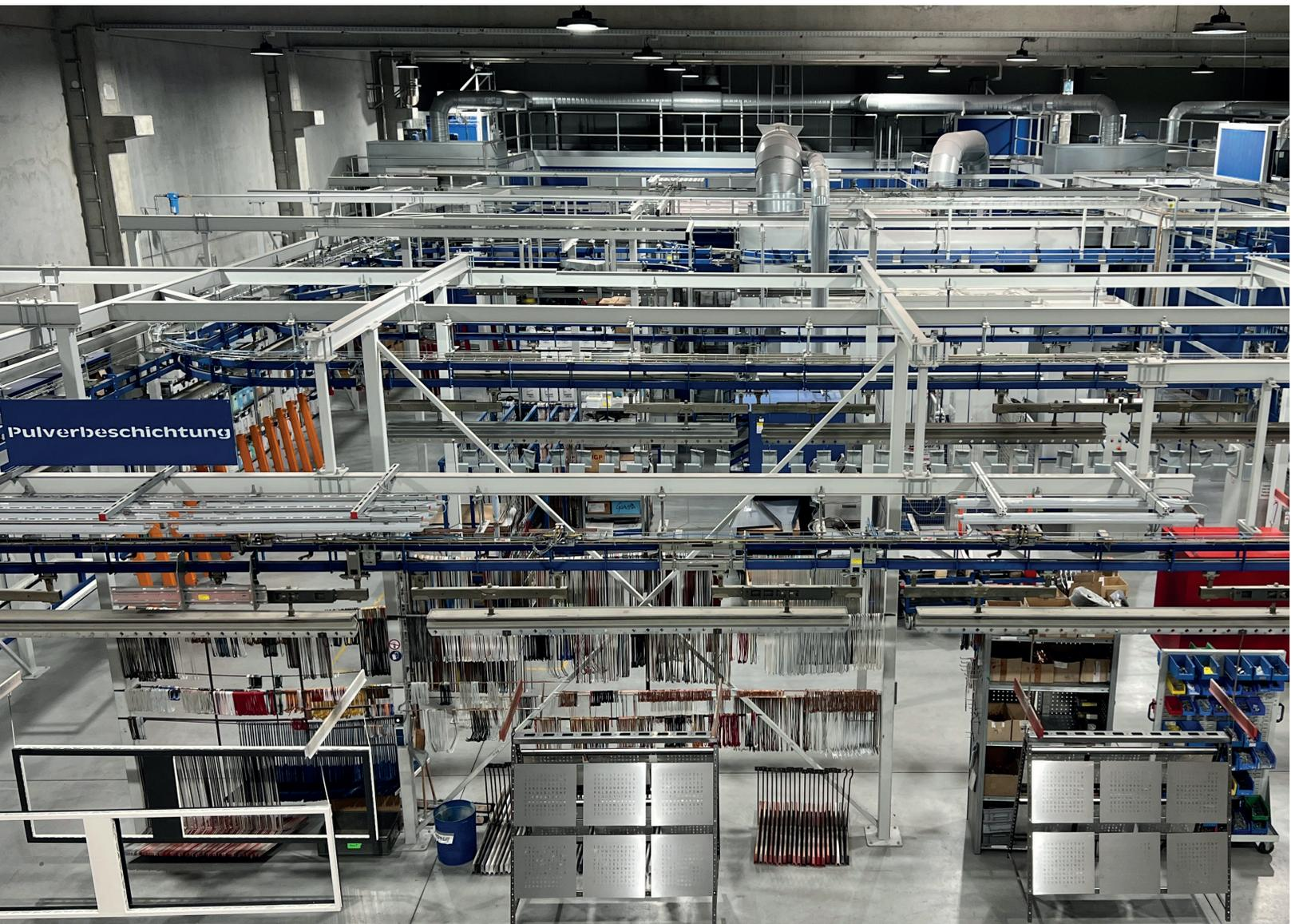
Blick in die Fertigung der Futronika AG: moderne Pulverbeschichtungsanlage mit Weichensystem
