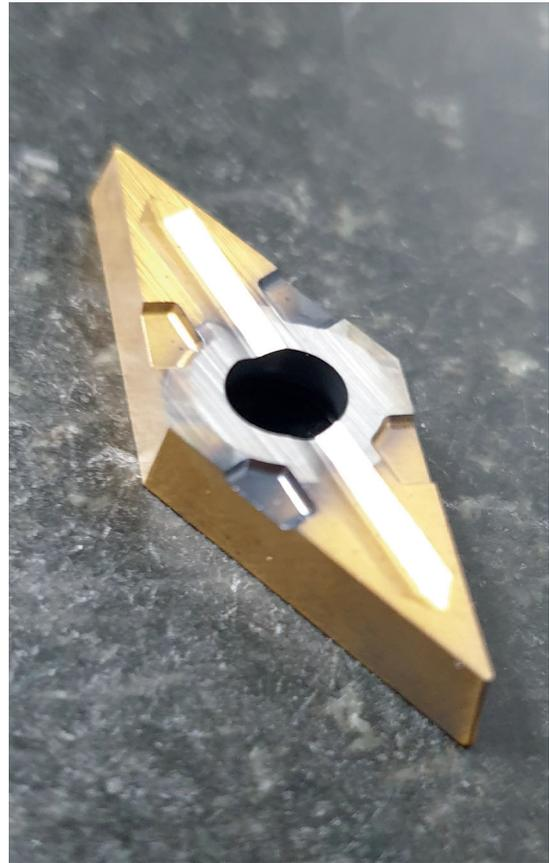
Die positive VBMX-Wendeschneidplatte ist an der Unterseite mit einer Rille versehen, die in die zugehörige Unterlegscheibe passt.
