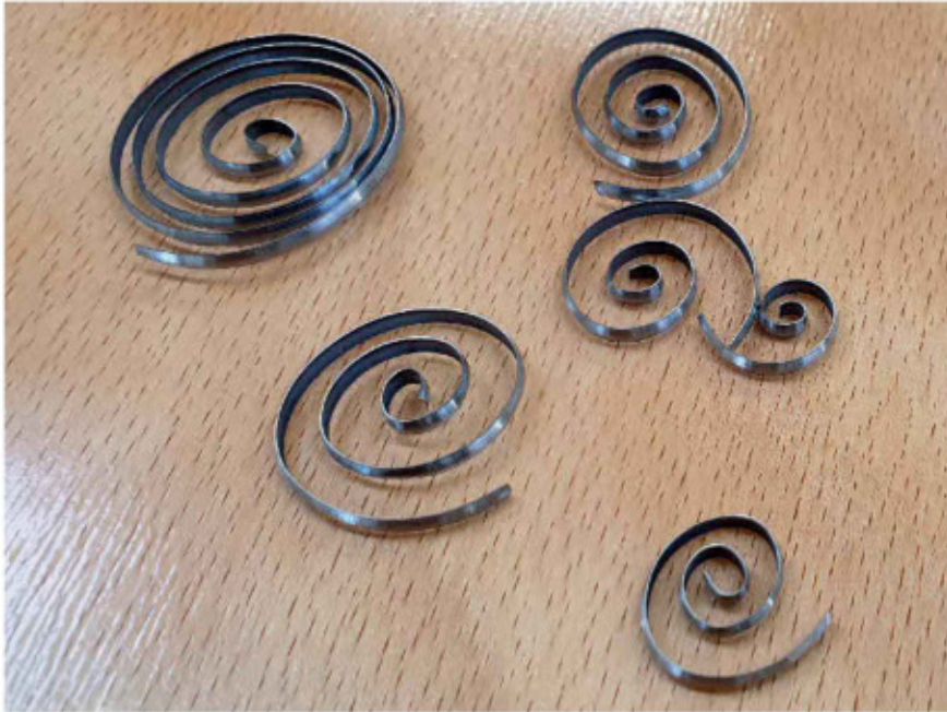
Bild 3. Optimale Spanbildung: Der WinCut erzeugt 3 mm breite Uhrfeder-Spiralen. Foto: Ingersoll
