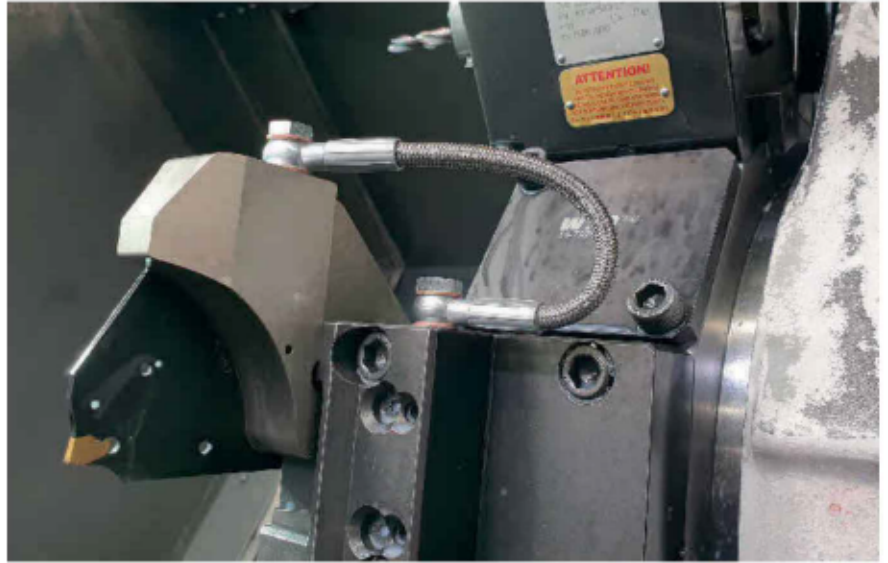
Bild 2. Innenkühlung per 3D-Druck: Das Kühlmittel wird durch Halter und Schwert zur Schneidplatte geleitet. Die gezielte Freiflächenkühlung von unten dient dazu, Späne aus dem Arbeitsraum heraus zu spülen. Eine zweite Düse kühlt die Schneide von oben. Foto: Ingersoll
