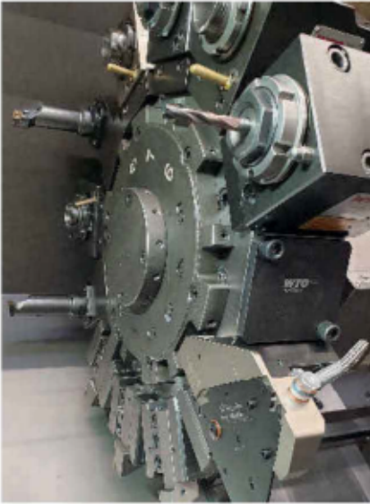
Bild 1. Das neue Abstechsystem hat seinen festen Platz auf dem Werkzeugrevolver der Okuma-Maschine gefunden. Künftig will es der Fertiger auch auf weiteren Maschinen einsetzen.
