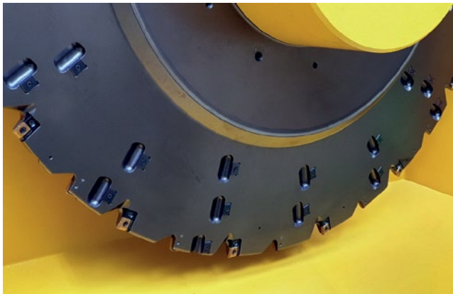
Die zur Schweissnahtvorbereitung eingesetzten Scheibenfräser von Ingersoll haben Durchmesser zwischen 850 und 1060 mm. Bestückt sind sie mit unterschiedlichen Schneidplatten für Kopf und Flanken des Werkzeugs.
