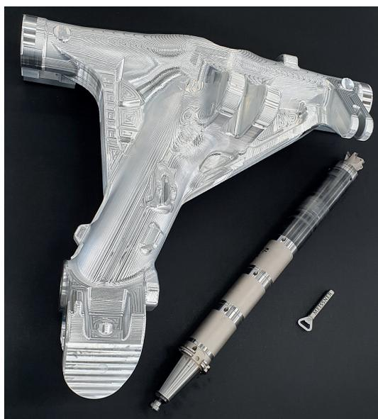
Bei Meissner wird das Landeibein des Fahrwerks komplett ausgehöhlt. Mit Elementen aus seinem INNOFIT System hat INGERSOLL das Werkzeug in der passenden Länge ausgelegt. Direkt hinter dem Fräser sitzt die schwingungsgedämpfte Verlängerung I-ABSORBER
