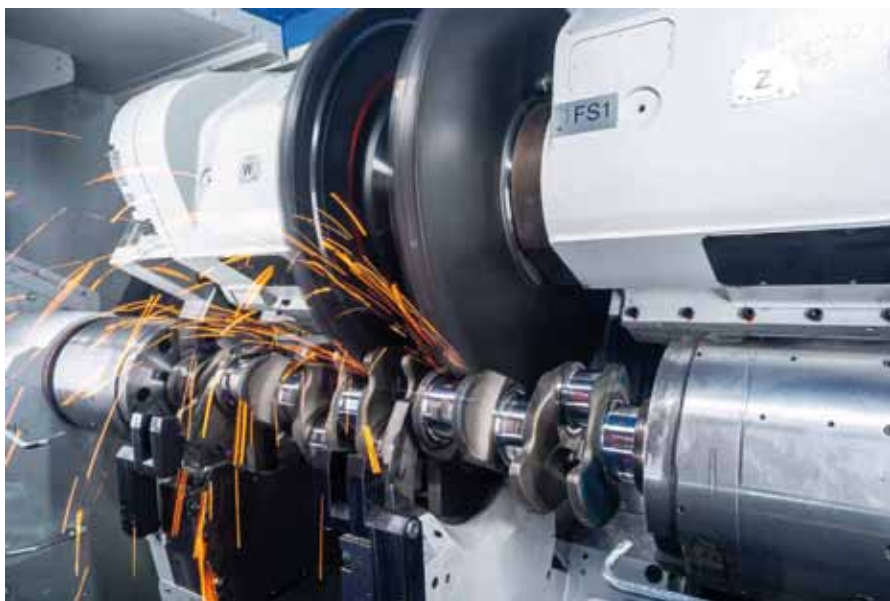
Bild: Hartfräsen von Kurbelwellen am Beispiel einer 6-Zylinder-Welle für LKW (Bild: INGERSOLL Werkzeuge GmbH, Haiger)
