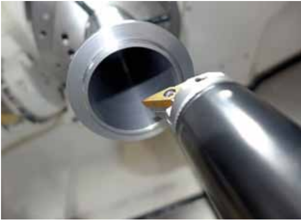
Bild 2: Das Bild zeigt die Oberfläche der bearbeiteten Bohrung. Die geforderte Oberflächengüte von Rz 16 wurde durch den vibrationsfreien Schnitt der Spezialbohrstange mehr als erreicht
