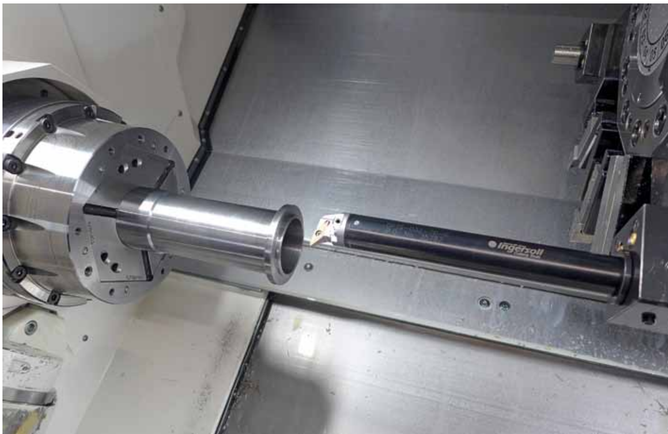
Bild 1: Bearbeitungssituation bei der Innenbearbeitung einer Hohlwelle aus hochfester Alu-Knetlegierung und dem Innendrehen einer 300 mm langen Bohrung mit Ingersoll T-Absorber Bohrstange
