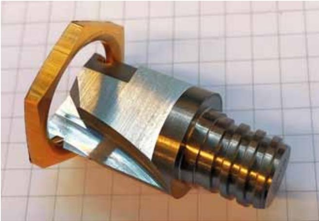
Bild 10: Das erfolgreich getestete Ingersoll-ChipSurfer-Werkzeug zur kompletten Innenbearbeitung der Messingmutter
