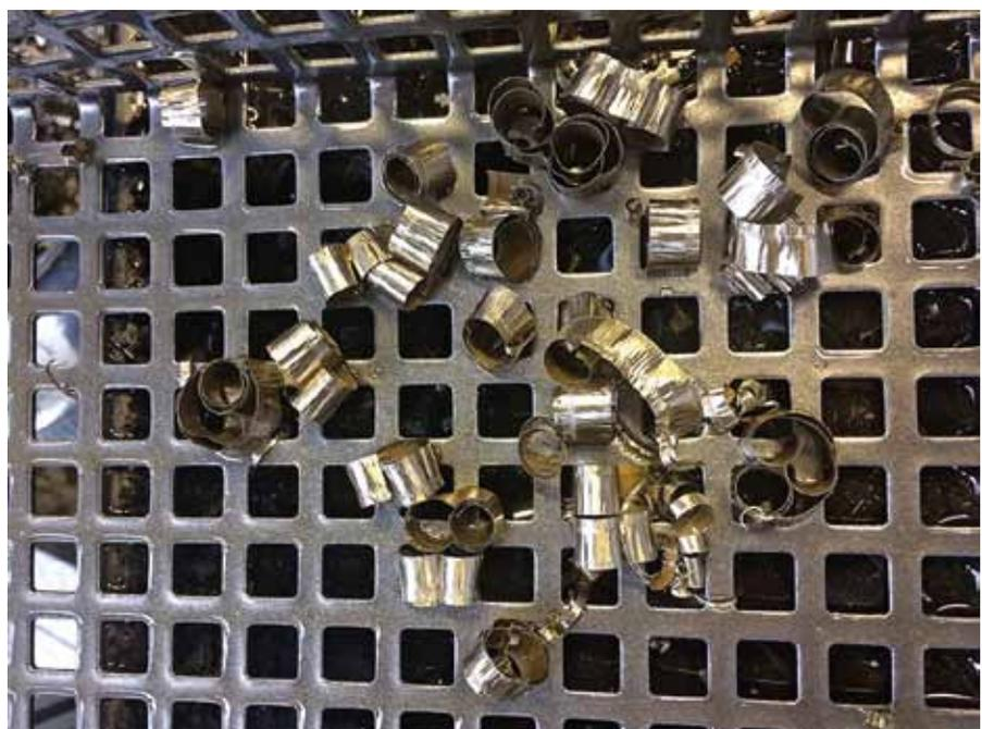
**Bild 4:** Späne der Ingersoll-Einstechplatte. Die kurzen Lockenspäne bereiten keinerlei Probleme im Späneförderer
