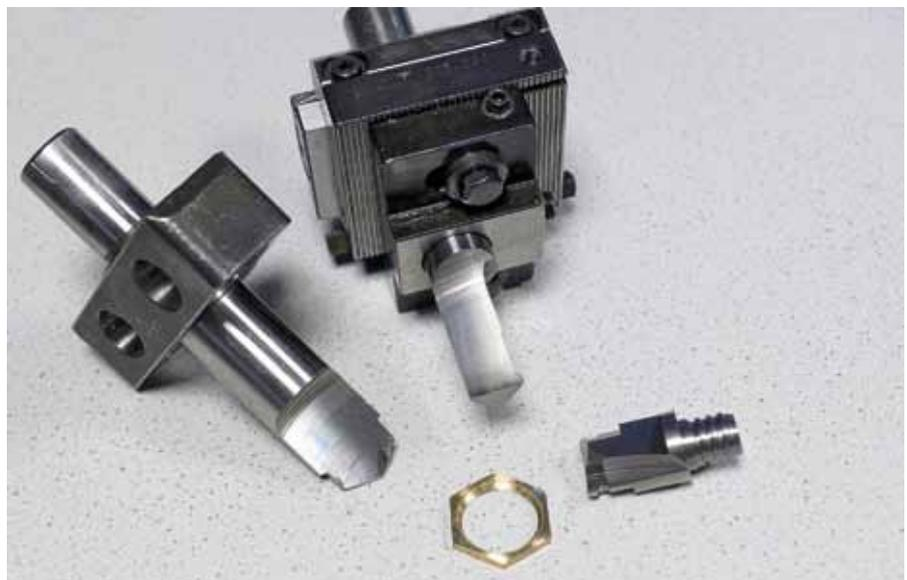
**Bild 9:** Vergleich der bisher eingesetzten Werkzeuge zum Bohren und Fasen mit dem getesteten Sonder-ChipSurfer (rechts)
