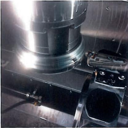
Bild 3: GoldFlex-Stechwerkzeug im vertikalen Einsatz bei der Bearbeitung des Testwerkstückes
