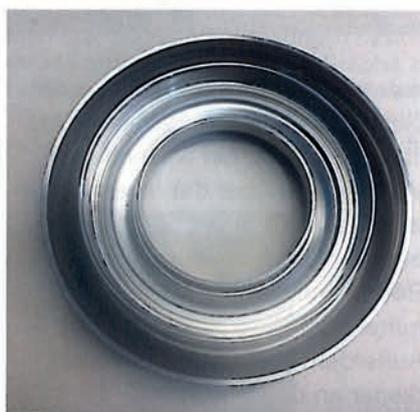
Bild 1: Werkstück „Kolben“ Bauteil eines Automatikgetriebes von einem bekannten Automobilhersteller
