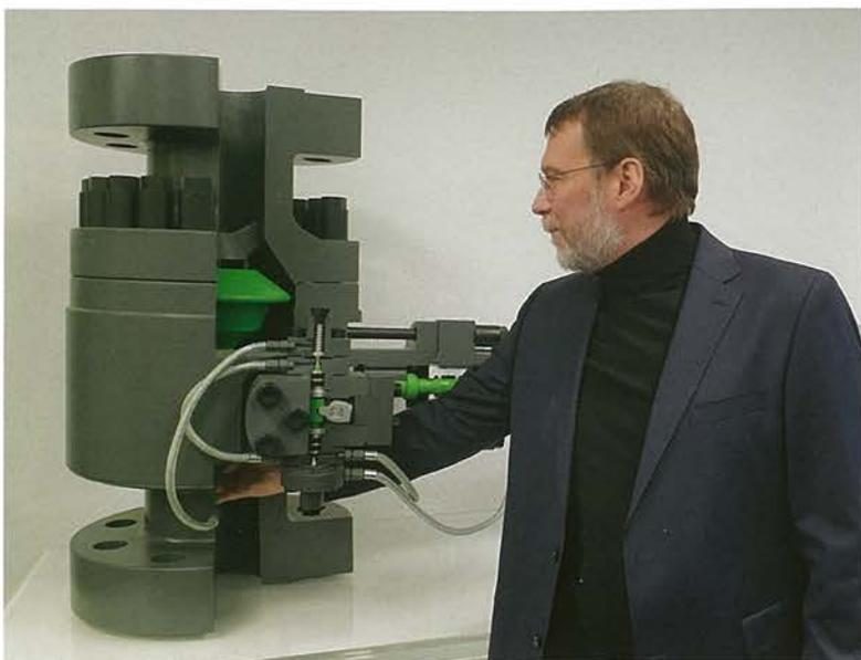
Am Modell erläutert Geschäftsführer Axel Mücher das Funktionsprinzip eines Freilauf-rückschlagventils. Der grüne Kegel in der Mitte regelt den Flüssigkeitsstrom nach rechts zum Bypass
