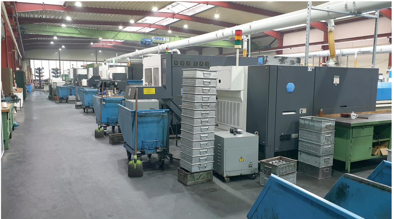
Auf einer Produktionsfläche von 2.100 Quadratmetern laufen bei Drexelius im Sauerland 21 Drehmaschinen
