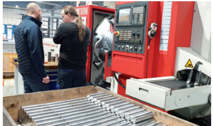
Drehteile werden bei der Beer Zerspanungstechnik grundsätzlich von der Stange gefertigt. Entsprechend häufig ist ein Abstecherwerkzeug gefragt.
