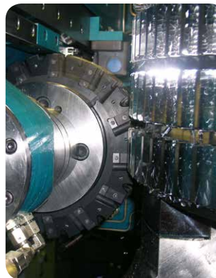
Fertigfräsen mit Wälzfräser Außenring Modul 10, z = 94 Werkstoff: 42CrMo4
