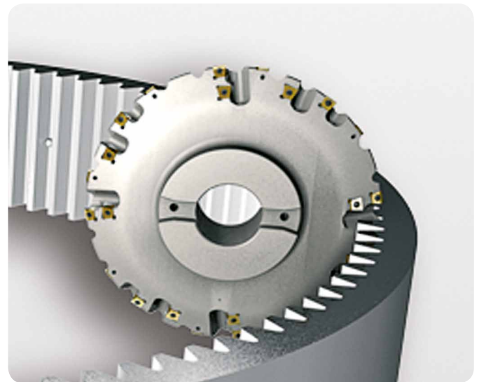
Vorfräsen eines Hohlrades Modul 16 Roughing of annulus module 16
