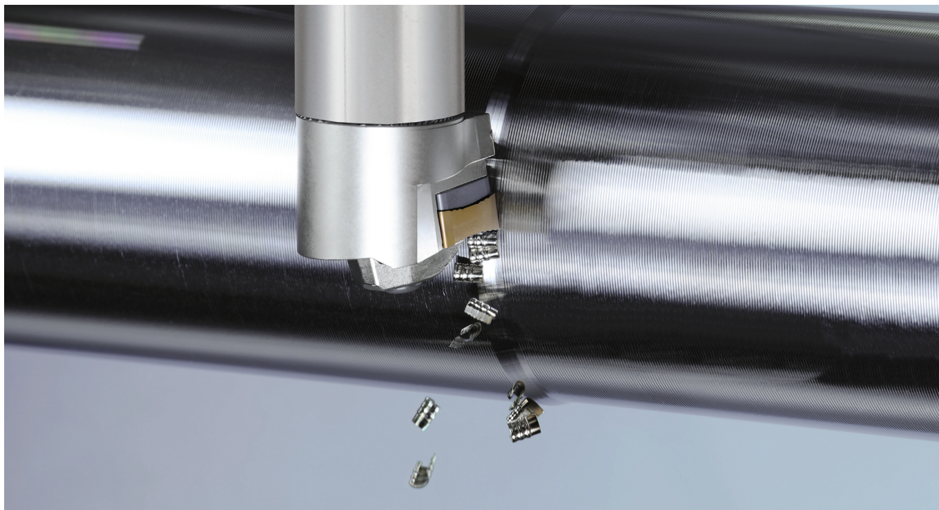
Drehen in der Y-Achse bedeutet, dass die Späne nach unten fallen und so das Werkstück nicht berühren
