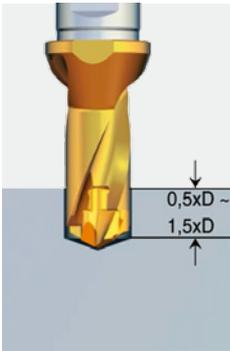
1. Lors de l'utilisation de forets longs (8xD et 12xD), il est recommandé de percer un avant-trou sur  $0,5xD$  à  $1,5xD$ .
