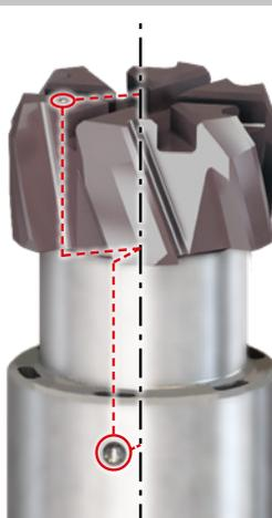
Mauvaise orientation entre le point de la tête et le support
