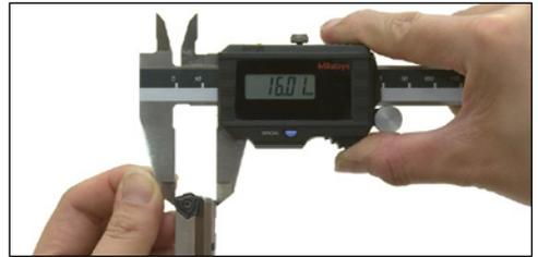
Diamètre réel d'usinage du foret: 16,03 - 16,04 mm
