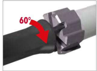
3.) Zugehörigen Klemmschlüssel im Uhrzeigersinn drehen, um den Reibkopf festzuziehen.
