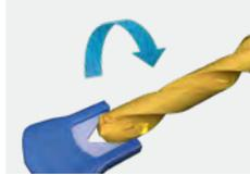
3. Bohrkopf durch drehen im Uhrzeigersinn montieren
