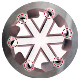
Die Kühlmittelbohrungen sind leicht sichtbar zwischen den Schneiden
