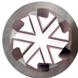
Die Kühlmittelbohrungen sind durch die Schneiden verdeckt
