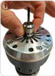
Fig. 32 Inserting nut
