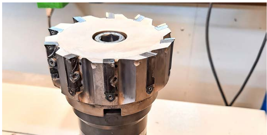
Ein eher seltener Anblick: Dank der hohen Standzeit des Bornitrids muss der mit CBN-Platten bestückte 4W5D125R00 nur alle paar Wochen zur Werkzeugvoreinstellung.
