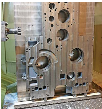
Die beiden Seitenteile für einen Druckturm bearbeitet Manroland gleich paarweise.
