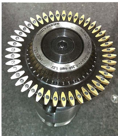
Bild 1. Der Werkzeugspezialist hat das Wälzschälwerkzeug mit 43 Wendeschneidplatten ausgestattet, die aus rhombischen Rohlingen profilgeschliffen wurden. Foto: Ingersoll
