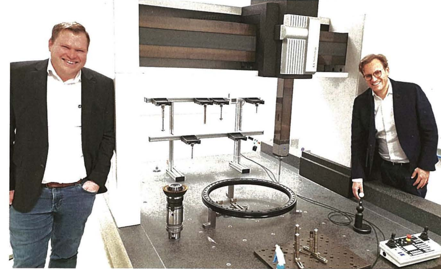
Bild 3. Florian Lemberger, Technischer Geschäftsführer von IBO (rechts), und Michael Bum, Technischer Berater bei Ingersoll, am Koordinatenmessgerät. Das gezeigte Bauteil muss die Verzahnungsqualität 8 nach DIN 3961 erfüllen. Die Innenverzahnung des Lagerrings, der hier bereits schwarz eloxiert ist, umfasst 189 Zähne. Foto: Ingersoll
