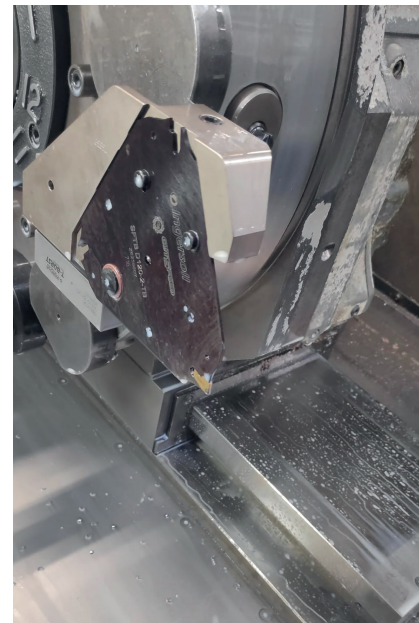
Bild 2. Mit dem dreieckigen Schneidträger gelingt auch das Abstechen von Bauteilen mit größeren Durchmessern problemlos. Foto: Flohr
