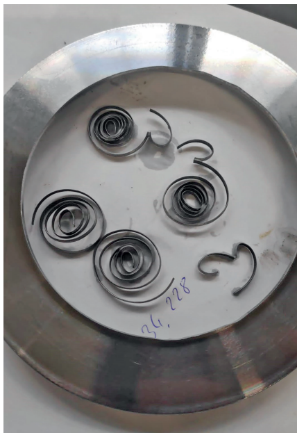
Bild 1. Das Abstechen mit „CutSFeed“ erzeugt saubere Oberflächen, die nicht mehr nachbearbeitet werden müssen. Im Zusammenspiel mit der Kühlung sorgen optimal eingestellte Schnittwerte für eine exzellente Spankontrolle. Foto: Flohr
