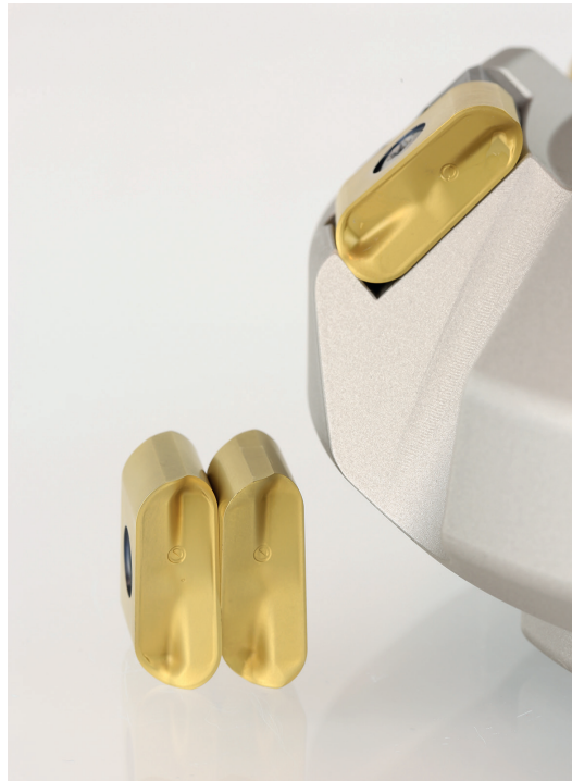
Die Wende-schneidplatten DPM436R101T12 sind sowohl mit PVD als auch mit einer darüberliegenden dicken CVD-Lage beschichtet
