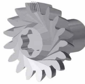
Komplett nachgeschliffenes Werkzeug / Completely reground tool
