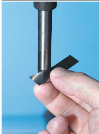
Abb. 4: Fühlerlehre darf NICHT in Verbindungslücke passen
