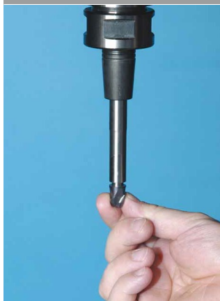
Abb. 4: Fühlerlehre darf NICHT in Verbindungslücke passen
