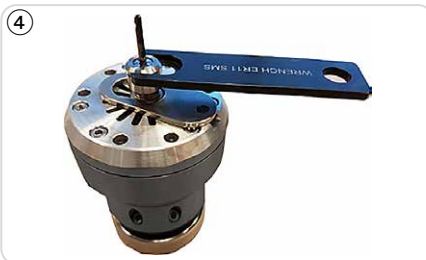
Abb. 34 a/b: Spannschlüssel ansetzen und festziehen
