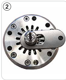
Abb. 33 a/b: Flache Schaftverriegelung aufsetzen und befestigen.
