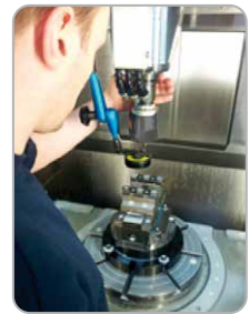
Abb. 37: Prüfen der Rundlaufgenauigkeit
