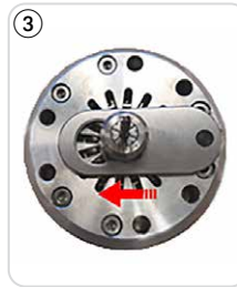
Abb. 33 a/b: Flache Schaftverriegelung aufsetzen und befestigen.
