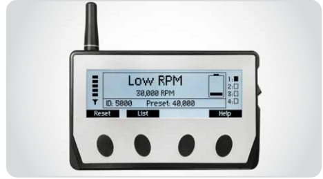
Abb. 26: Anzeige: Drehzahl zu niedrig
