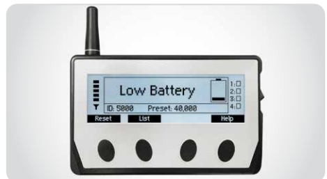
Abb. 25: Anzeige: Batterie schwach
