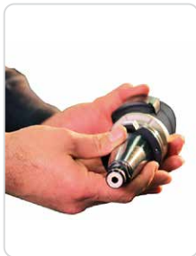
Abb. 30: Beispiel einer Werkzeugaufnahme mit Kühlmittelbohrung
