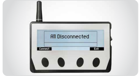
Abb. 22: Anzeige alle Sensoreinheiten getrennt
