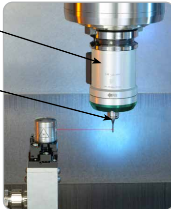
Abb. 36. Optische Prüfung des Rundlaufs
