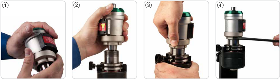
Abb. 29 Einsetzen der HSM GreenJet Spindel in die Werkzeugaufnahme
