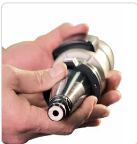
Abb. 30 Beispiel einer Werkzeugaufnahme mit Kühlmittelbohrung
