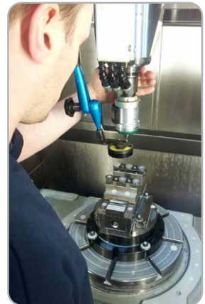
Abb. 37. Manuelle Prüfung des Rundlaufs
