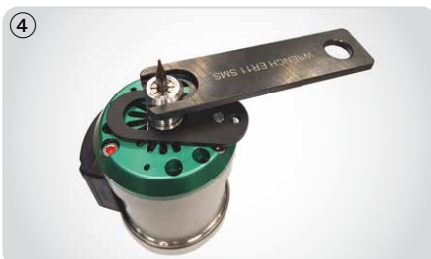
Abb. 35 Schlüssel in Nuten setzen, im Uhrzeigersinn drehen
