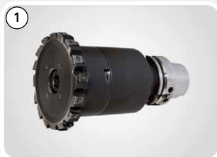
1 Schruppen (Deckseite) Roughing (Top face)
