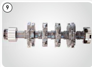
9 Schruppen Lagerstegbreite und Aufbohren Kurbelwellenhalbrund Roughing of crank bore cheeks and boring of crankshaft half
