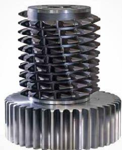
Fertigfräsen mit Wälzfräser
