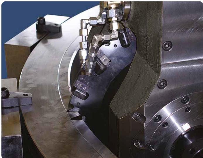
**Fertigfräser mit formgeschliffenen Wendeschneidplatten**
